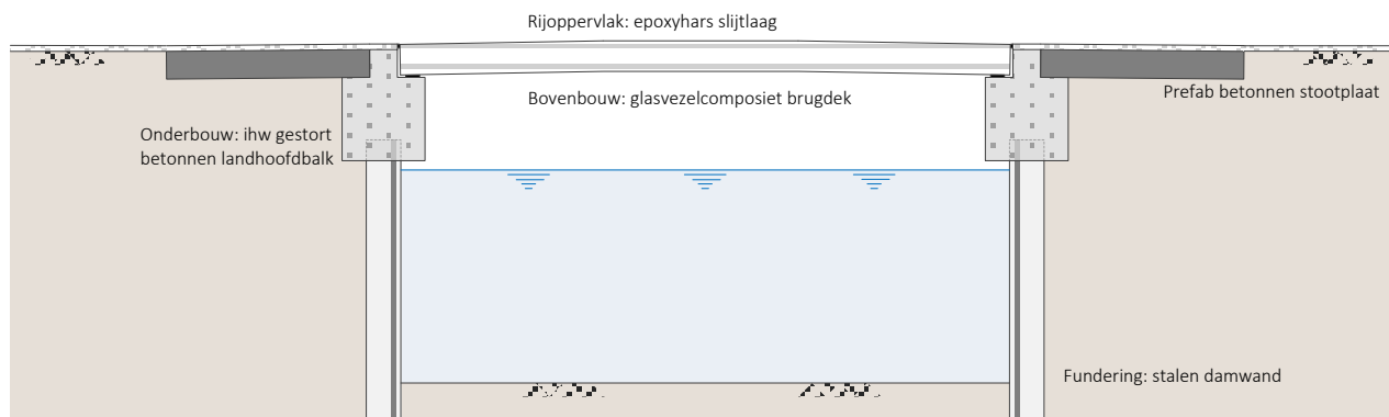
Afbeelding 5.1: Schematische doorsnede van de glasvezelcomposietbrug
